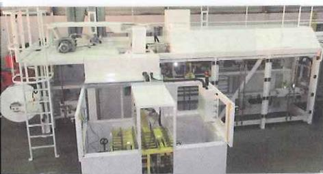
cloison, de la zone « avant » réservée au produit et la zone arrière kilomètre dédiée aux commandes techniques (mécanique, électrique et pneumatique). En option, l'ensacheuse peut être équipée d'un dispositif de changement automatique de format.
