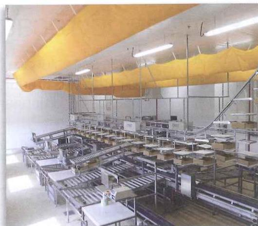
Ainsi, les utilisateurs disposent de transfert plus automatique, sans pour autant être soumis à des process lourds d'automatisation. Les transferts, par exemple, de la formeuse de carton au convoyeur aérien s'effectuent directement sans autres interventions extérieures. De même pour les bacs, l'outil de déchargement permet d'alimenter la laveuse en continu.
